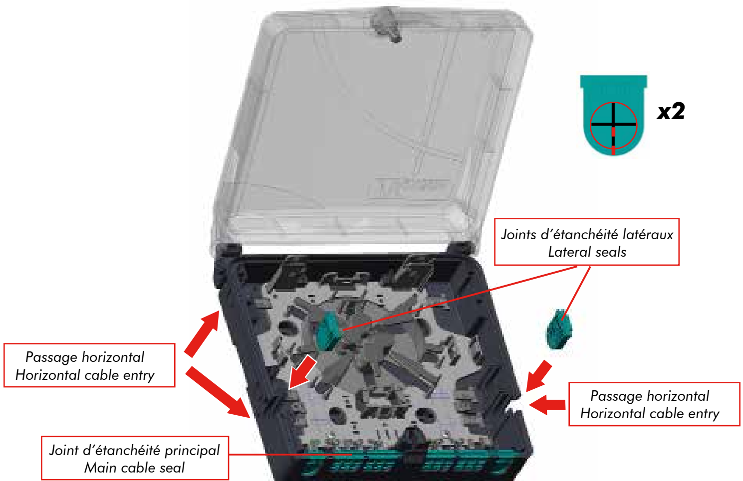
Fig. Mise en place des joints d'étanchéité Installing the cable seals
