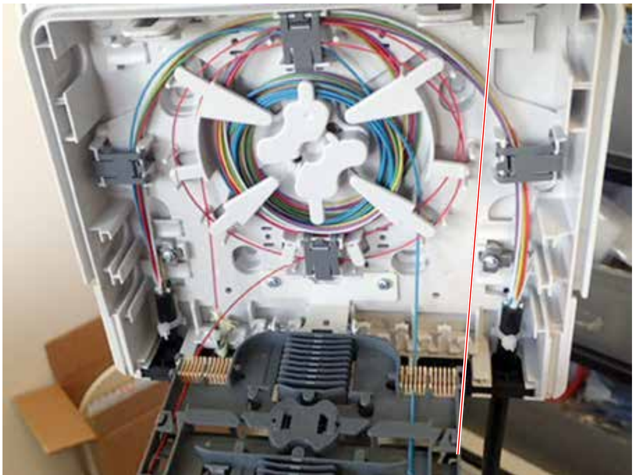
Fig. Cheminement des fibres à dériver - Vue face intérieure cassette Routing of fibres to be shunted - Tray inner side view
